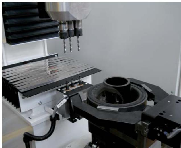
Dispositivo per il controllo delle misure dimensionali effettuate tramite un'apparecchiatura ottica. Viene eseguito il controllo su una quota assoluta e sul run-out radiale e laterale.
