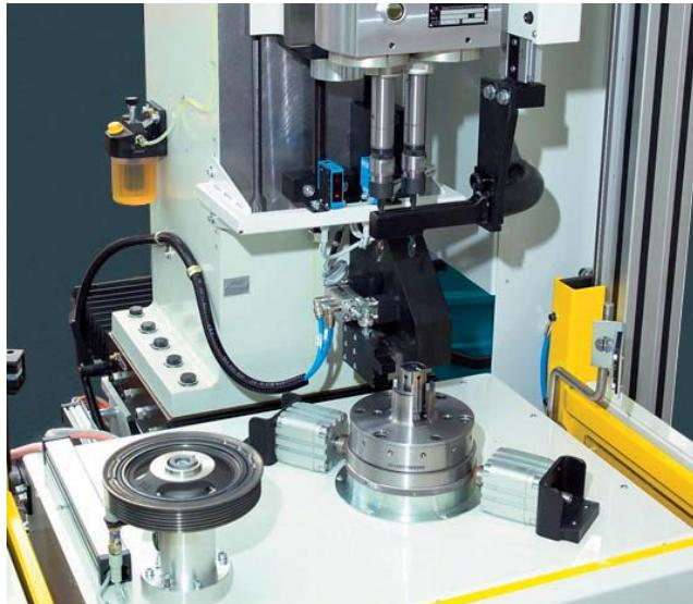
Particolare dispositivo testina tripla e controllo rottura punta.
