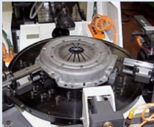
Automatische Auswuchtmaschine für Kupplungen mit automatisch gesteuerter Bohreinheit.
