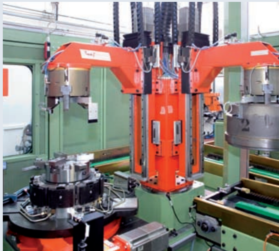
Automatische Auswuchtmaschine für LKW-Bremstrommeln mit automatischer Beladeeinrichtung und Fräseinheit.
