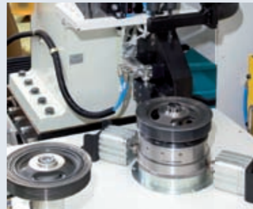
Automatische Auswuchtmaschine für Riemenscheiben mit automatisch gesteuerter Bohreinheit.
