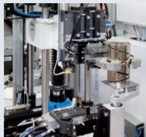
Automatische Auswuchtmaschine für Komponenten von Textilmaschinen mit automatischer Beladeeinrichtung und Bohreinheit.
