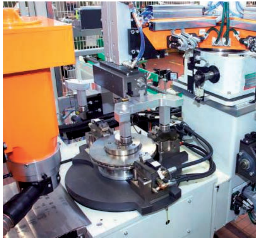
Automatische Auswuchtmaschine für Bremsscheiben mit automatischer Beladeeinrichtung und Fräseinheit.
