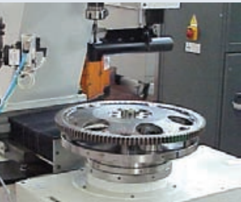
Vollautomatische Auswuchtmaschine für Schwungräder mit elektro-pneumatischer Bohreinheit und Unwucht-Makiereinrichtung.
