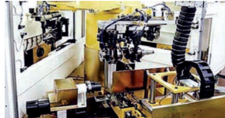
Vollautomatische Auswuchtmaschine für Kurbelwellen komplett mit automatischer Be- und Entladung.
