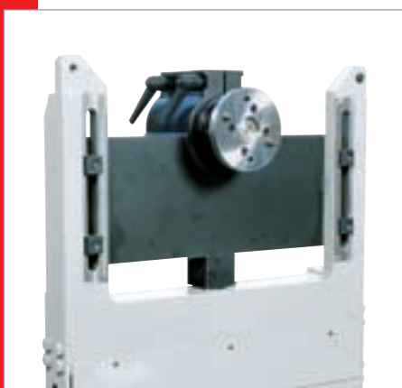
Flanscheinsatz zum Auswuchten von Antriebswellen. Flanged carriage for balancing drive shafts.
