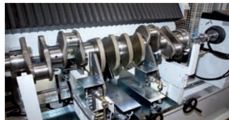
Halbautomatische Auswuchtmaschine für LKW-Kurbelwellen. Massenausgleich durch Bohren.
