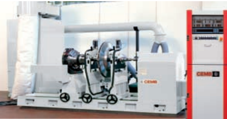
Halbautomatische Auswuchtmaschine für Gaskompressoren. Massenausgleich durch Schleifen.
