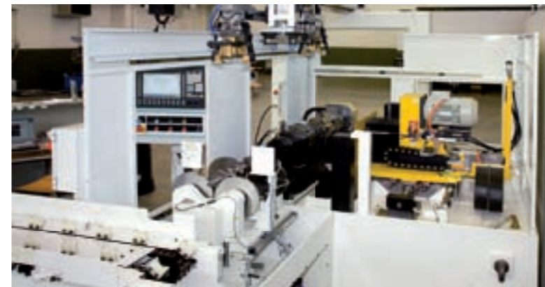
Vollautomatische Auswuchtmaschine für Kurbelwellen komplett mit Ladeportal.
