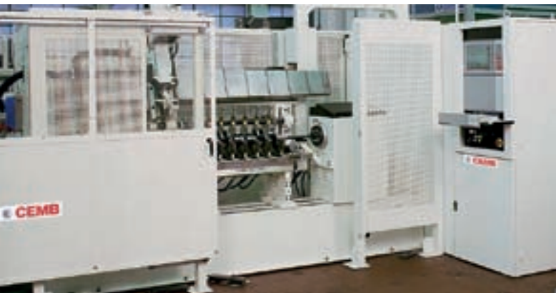
Halbautomatische Auswuchtmaschine für Kurbelwellen. Massenausgleich durch Bohren.
