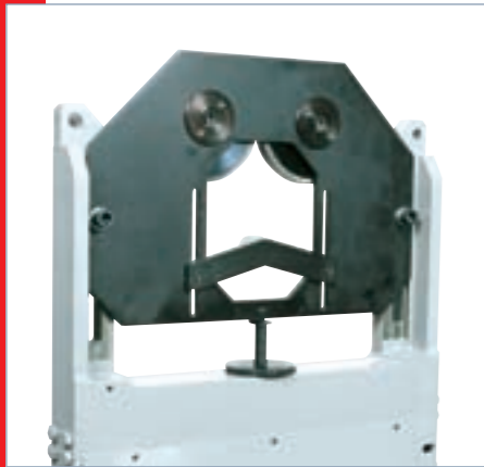
Gegenrollenlager für fliegend gelagerte Rotoren. Reverse thrust carriage for overhung balancing.
