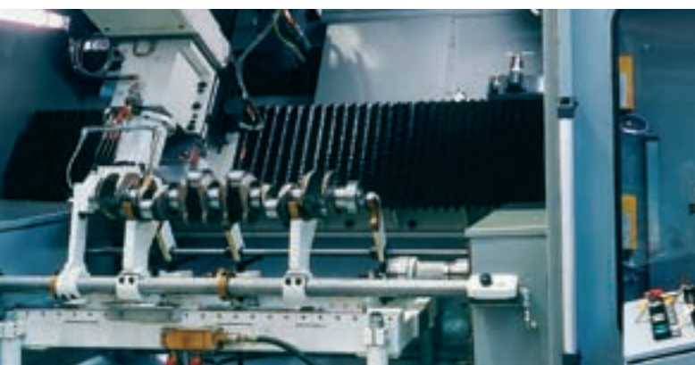
Halbautomatische Auswuchtmaschine für LKW-Kurbelwellen. Massenausgleich durch Bohren.
