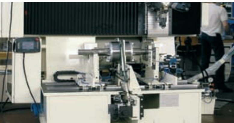
Automatische Auswuchtmaschine für Elektroanker. Massenausgleich durch radiales Bohren.
