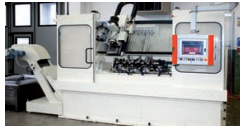
Automatische Auswuchtmaschine für LKW-Kurbelwellen. Massenausgleich durch Bohren.
