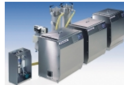
Tvättsteg: m80i Ultraljudstvätt med 10"sluten cirkulerande filtrering. Tvästegs kaskad pumpning P2S bestående av sluten cirkulerande sköjlvattenfiltrering med aktivt kol och avjonisering.
