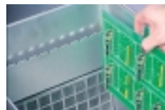
m40 & m80 jet lämpar sig väl för lösningsmedel, ger bättre agitering av vätska än dopptvätt
